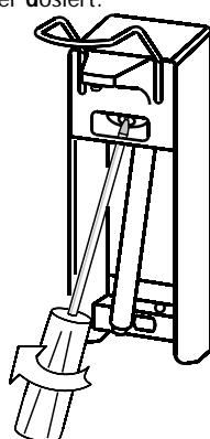
De dosering is optimaal ingesteld. Dosering kan verlaagd worden door met schroeven-draaier 1/8 tegen klok in te draaien.
